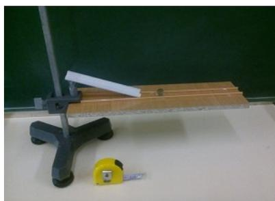
Rampa de lanzamiento, plataforma , papel de calco, cinta métrica y bola de acero.
